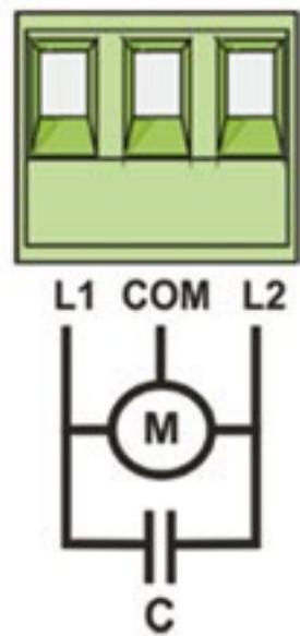
1.2. اتصال موتور به مرکز کنترل
