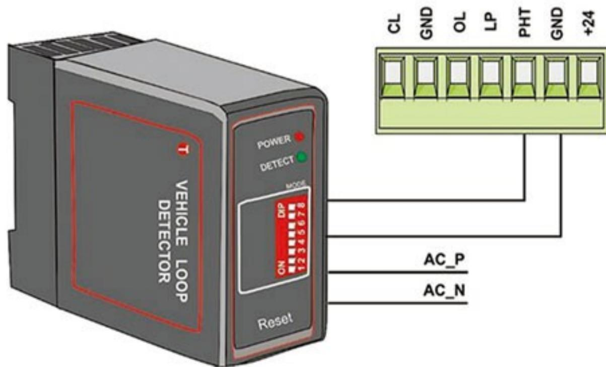
Loop detector NC: اگر راهبند در حال بسته شدن باشد با قرار گرفتن خودرو در محدوده حلقه، راهبند باز خواهد شد و اگر باز باشد تا عبور خودرو از محدوده حلقه گیت باز خواهد ماند.
